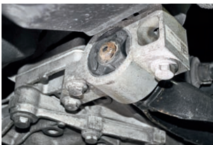
Сильно изношенный задний сайлент-блок разбивает палец переднего рычага. Для замены часто заимствуют более жесткий сайлент-блок от Audi S3: его резиновая часть цельная, без прорезей, и служит дольше
