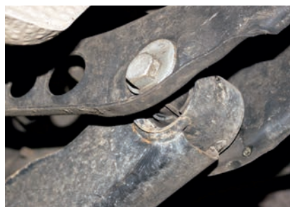
Сзади первыми из строя выходят сайлент-блоки коротких, «подруливающих» поперечных рычагов, а следом — и длинных основных (на фото)
