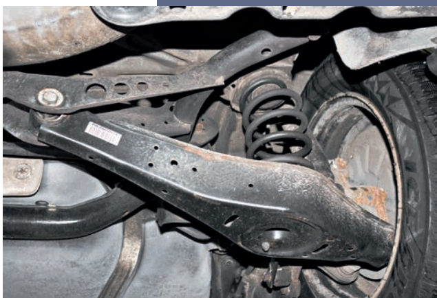
Задняя многорычажная подвеска способна продержаться в полтора раза дольше передней
