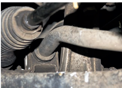
Втулки стабилизаторов несъемные: оригинальный узел поставляется в сборе
