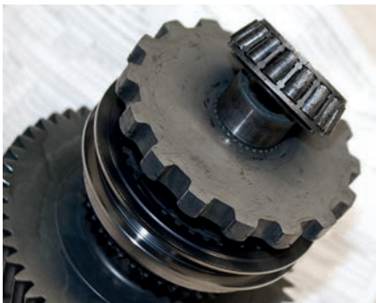
Чем старше семиступенчатый «робот», тем рискованней. У этого экземпляра с дорестайлингового автомобиля критически износился подшипник вторичного вала
