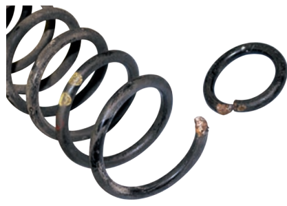
Версии с пакетом для плохих дорог слабы задними пружинами: обычно ломается нижний виток
