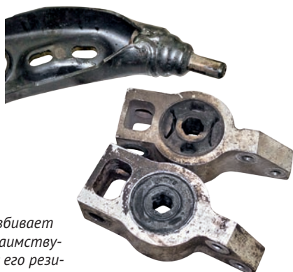
Сзади первыми из строя выходят сайлент-блоки коротких, «подруливающих» поперечных рычагов, а следом — и длинных основных (на фото)
