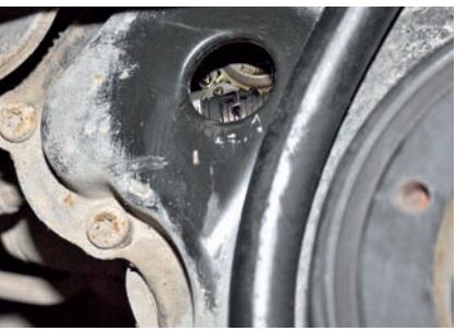
Определить, менялась ли цепь, можно через диагностическое окно — по модернизированному натяжителю (на фото)
