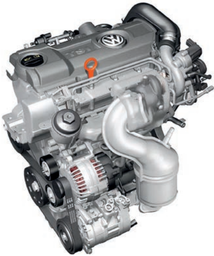
Турбомотор 1.4 с чугунным блоком цилиндров и алюминиевой головкой из появившейся в 2005 году серии EA111 пришел на смену атмосферным двухлитровым «четверкам»
