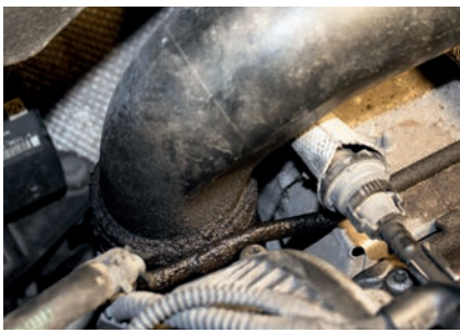
Такое состояние подводящего патрубка турбокомпрессора — повод проверить систему вентиляции картера
