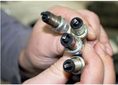
Подобное состояние свечей указывает на то, что мотор начал сверх меры подъедать масло
