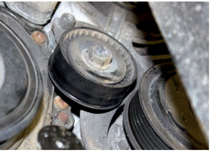
У натяжителя ремня навесных агрегатов быстрее изнашивается не подшипник, а сам пластиковый шкив
