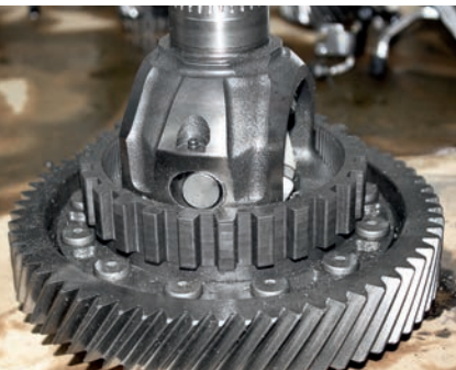
А так выглядит разбитое посадочное место оси сателлитов дифференциала с обломанным фиксатором у шестиступенчатого «робота»
