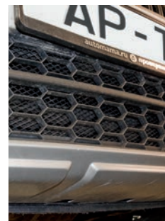
Установка сетки на нижнюю решетку бампера — полезная доработка, оставляющая изыщному конденсатору кондиционера (на фото справа — последствия его «обстрела») больше шансов выжить
