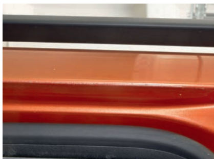
Протертая до грунта краска в дверном проеме — результат трудов уплотнителя
