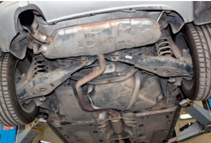
Задние подвески у переднеприводной (на фото) и полноприводной версий — одной конструкции. Из основных «суставов» сади первыми устат соединения продольных тяг
