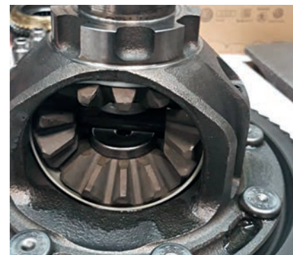
Механические коробки передач слабы подшипником дифференциала
