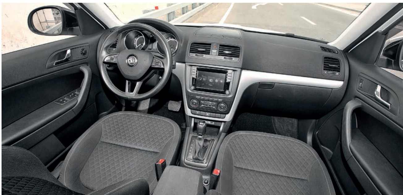
Многие элементы в салоне, включая переднюю панель, поскрипывают смолоду. «Стекла» приборов очень легко царапаются
