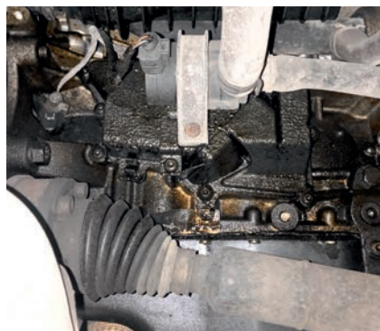
Первопричина подобной неоправданности мотора 1.2 — забившийся маслоотделитель
