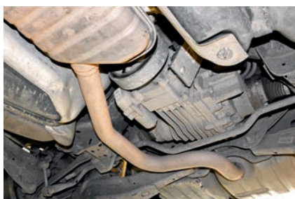
Муфты Haldex четвертого (на верхнем фото) и пятого поколений легко отличить внешне
