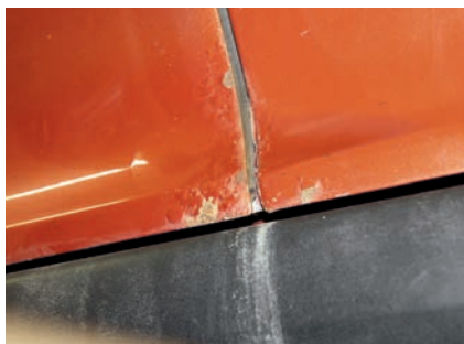
Подобная коррозия на пожилых экземплярах отнюдь не редкость. Белесость на некрашеном пластике порога — следы преступления междверного уплотнителя
