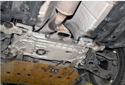
Вот такой передний алюминиевый подрамник на некоторых автомобилях до 2013 года — предпосылка ускоренного выхода из строя сайлент-блоков рычагов
