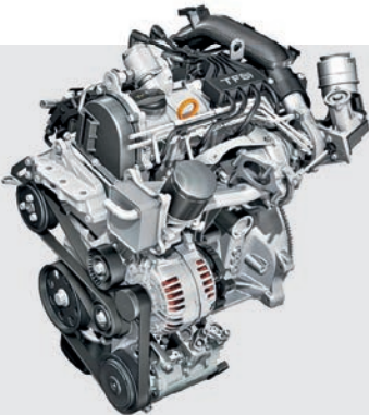
Восьмиклапанник 1.2 серии EA111, в отличие от старшего брата 1.4, имеет не чугунный, а легкосплавный блок цилиндров
