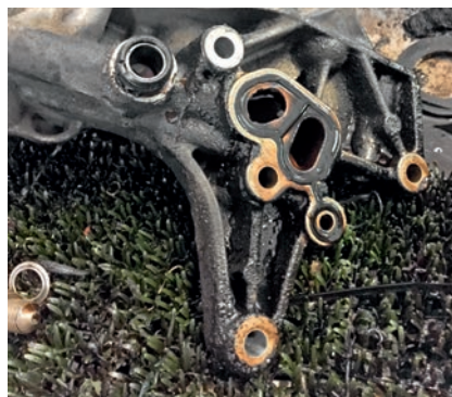
У кронштейна генератора и масляного фильтра двигателя 1.2 — целая коллекция ненадежных прокладок
