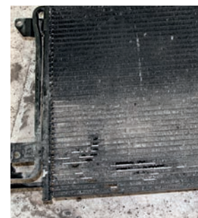
Установка сетки на нижнюю решетку бампера — полезная доработка, оставляющая изыщному конденсатору кондиционера (на фото справа — последствия его «обстрела») больше шансов выжить
