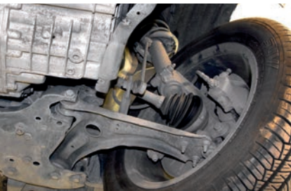
Выносливые шаровые опоры стальных передних рычагов меняются отдельно
