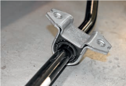
В отличие от задней подвески, при износе втулок передний стабилизатор подлелжит замене в сборе
