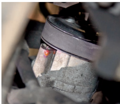
Водяной насос у двигателей 1.2 способен потечь всего через 30–50 тысяч километров
